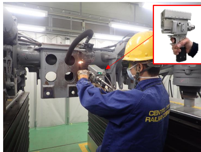
〔新規〕 レーザによる塗膜除去
