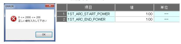
変更後、[送信]ボタンを押すことで光ファイバ融着機に反映されます。送信せず に他のメニューに移った場合、変更した値は破棄されます。
