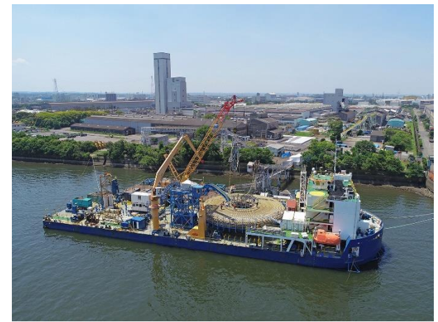
海底ケーブルの船積みの様子
