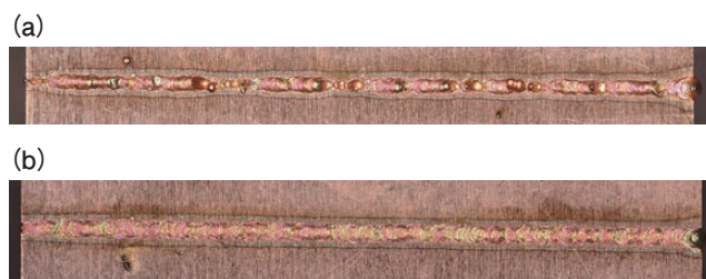
図10 純銅板の溶接ビードの様子 Optical images of beads on plates with copper plate test. (a) ビームモード制御技術無し Conventional focused beam (b) ビームモード制御技術有り With beam mode control technology
