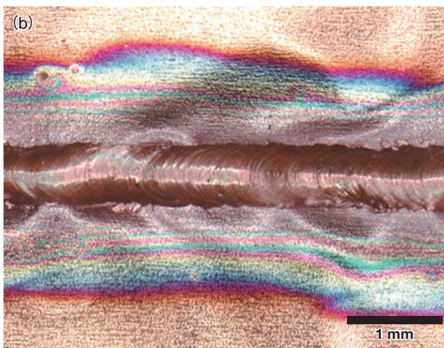
図12 アルミニウム板溶接時の様子 Welding aluminum plates. (a) ビームモード制御技術無し Conventional focused beam (b) ビームモード制御技術有り With beam mode control technology
