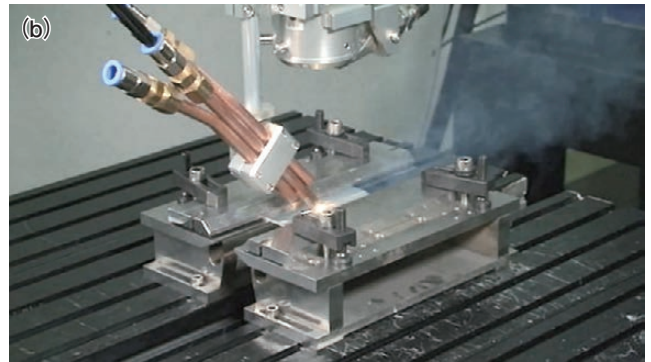
図12 アルミニウム板溶接時の様子 Welding aluminum plates. (a) ビームモード制御技術無し Conventional focused beam (b) ビームモード制御技術有り With beam mode control technology
