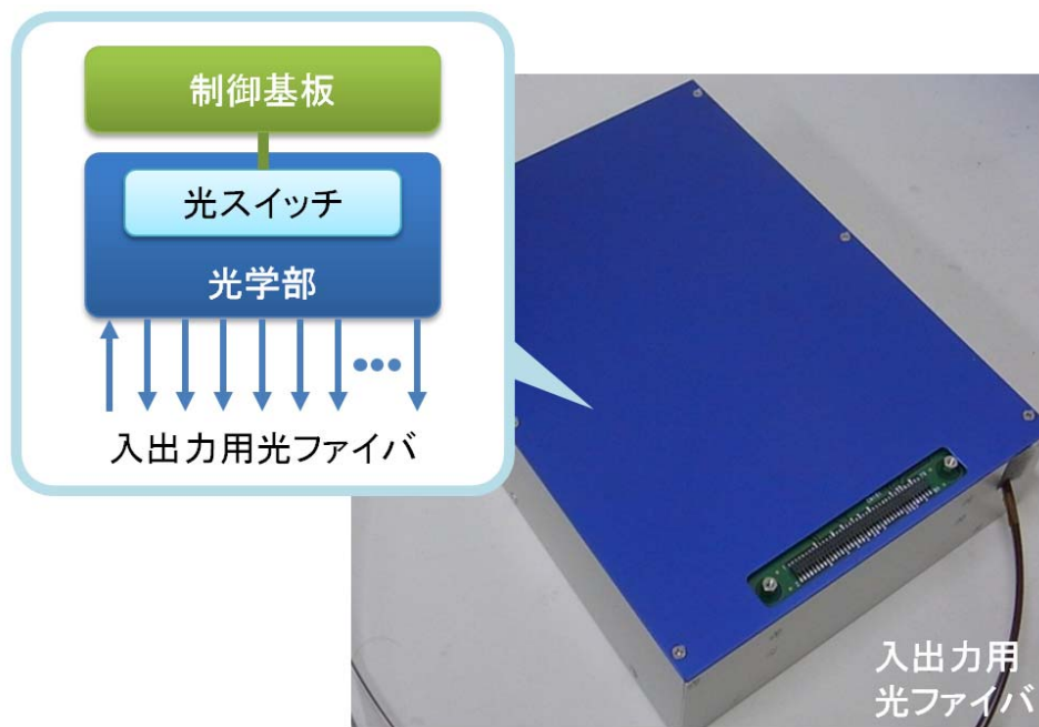
図7 多ポート波長選択スイッチの試作機の写真(古河電工)
